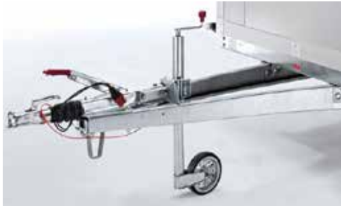
Lange Zugdeichsel (Ausführung je nach Modell)
