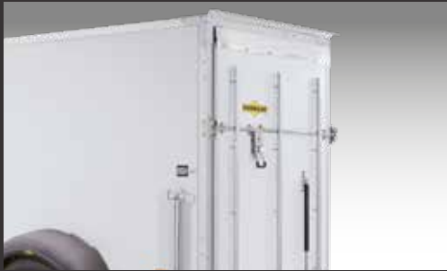
Überfahrwand anstatt Tür hinten
