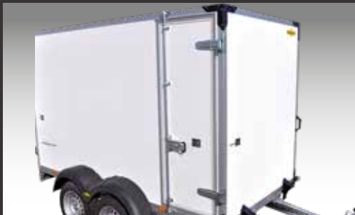
Seitentür mit Drehstangenverschluss von Innenhöhe 1500 - 2300 mm
